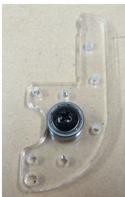
FA12 の亚克力パーツに写真の向きで固定します。 ベアリングが軽く回るか指で確認して下さい。 ベアリングが回らない時はベアリングの表裏を反対にします。
