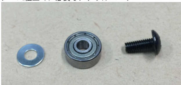
左から M4 平ワッシャ ベアリング 624ZZ M4-10 トラスねじ を準備します。
