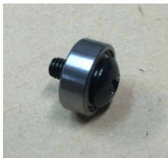
写真の様に組みます。 ベアリングの左に平ワッシャ ベアリングの右にトラスねじ
