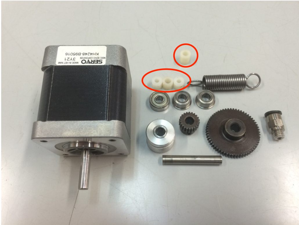
分解したフィーダーの部品(ネジ・ナット類以外) 赤丸のスペーサー4個は使用しません。
