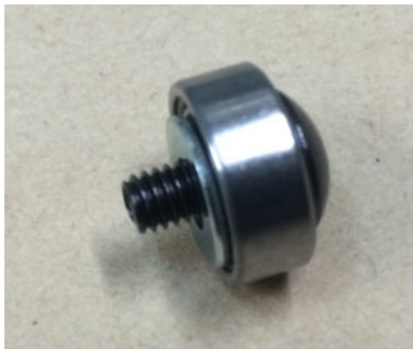
写真の様に組みます。 ベアリングの左に平ワッシャ ベアリングの右にトラスねじ
