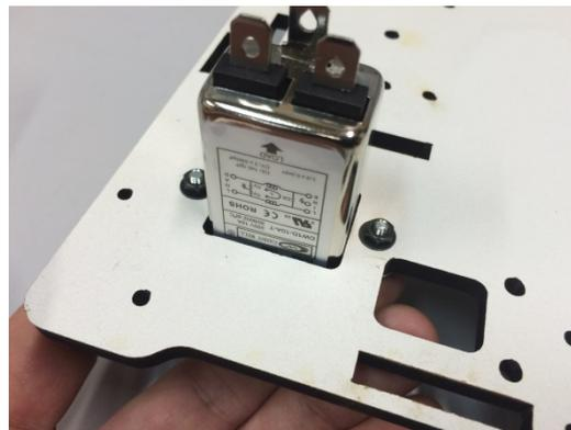
皿ネジが落ちないように手を添えて板を裏返し、平ワッシャ、ナットの順で取り付けてネジを締め付けます。 ノイズフィルタ取付完了です。
