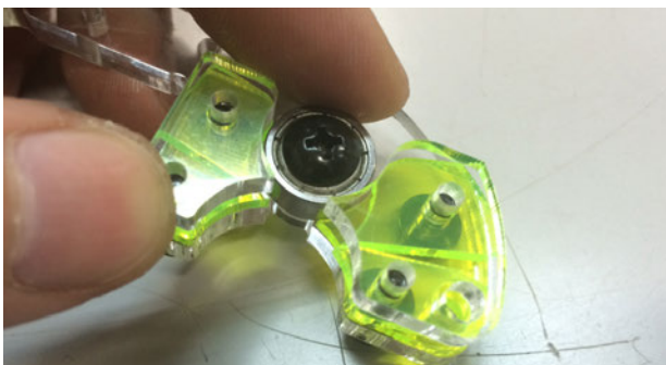
指でベアリングが回るか確認して下さい。回らない時はベアリングの表裏を反転させて固定して下さい。
