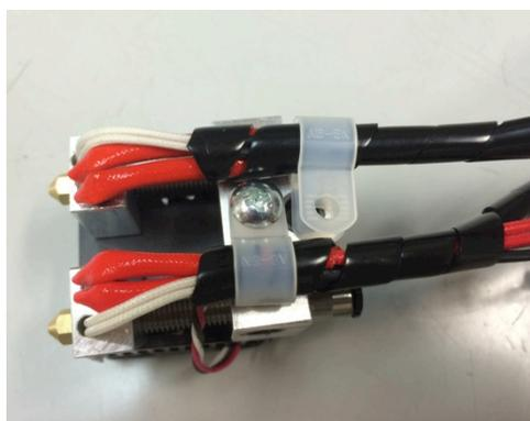
チューブを寄せて、ケーブルクランプを取り付けます。
