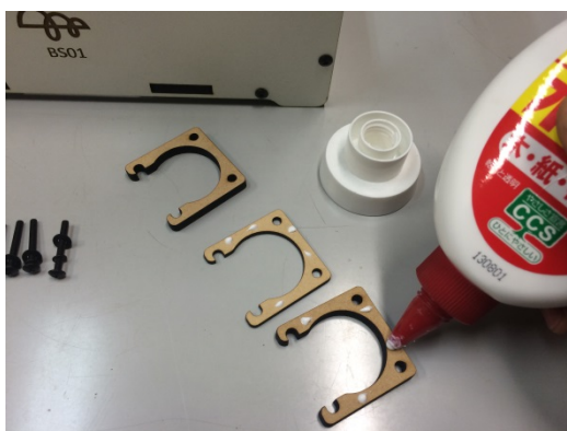
5.5mm 2.5mm 5.5mm モーターブラケットを 3 枚重ねボンドで接着します。
