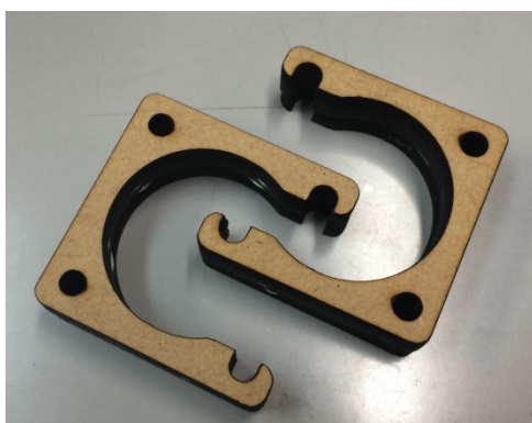
5.5mm 2.5mm 5.5mm モーターブラケットを 3 枚重ねボンドで接着します。
