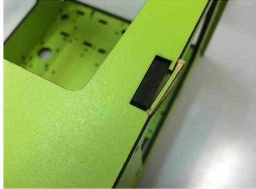
注意 :BS01 の木製筐体は通常は削らず組めるように注意して製造しておりますが、もし穴が小さくて入らない場合は、本体側の穴をヤスリで少しだけ削って下さい。
