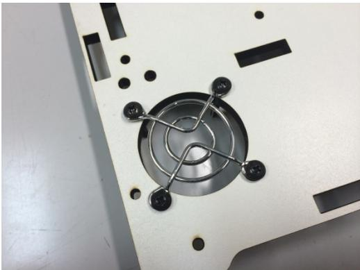
フィンガーガードを置いて、穴にトラスねじを挿し、手を添えて板を立てます。
