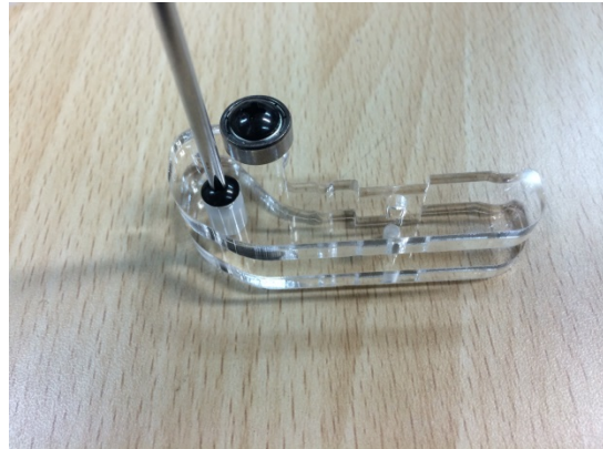
M3-14 トラスねじでアームを重ねて固定しま
