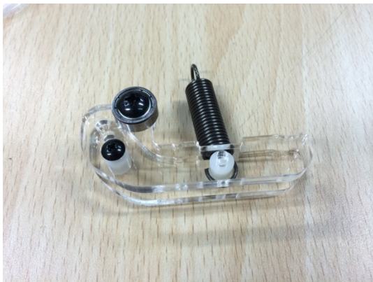
M3 スペーサー厚さ 6mm とテンションスプリングを写真のようにセットします。
