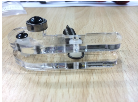
M3 スペーサー厚さ 6mm とテンションスプリングを写真のようにセットします。
