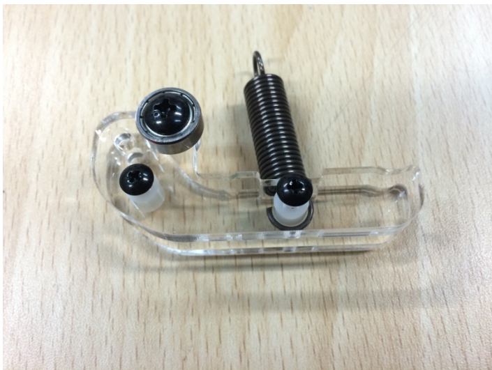
M3-14 トラスねじで固定したら、アームの出来上がりです。
