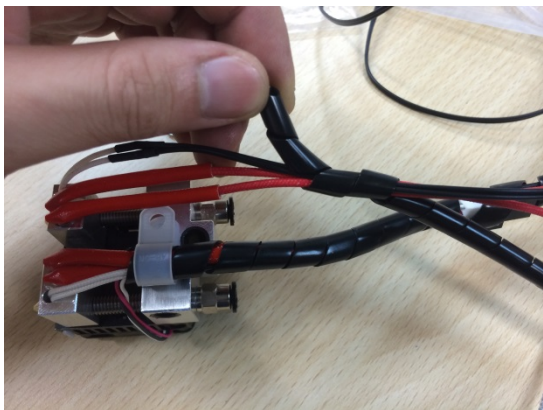
スパイラルチューブを写真の位置だけ巻きます。 丁寧にヒーター側に寄せます。
