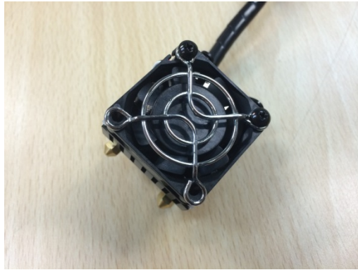
フィンガーガードを乗せて M3-25 トラスねじで固定します。
