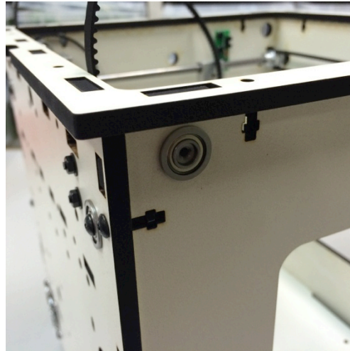
右奥は調整側締め付け
