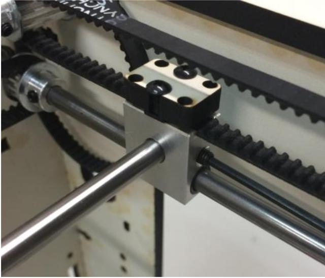
一度抜いて再度スライダに差し込んだヘッドロッドは、ホーローセットで固定して下さい。
