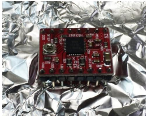
デュアルの追加部品からジャンパーピン 3 個とモータードライバーを準備します。
