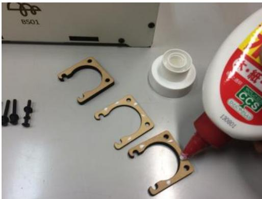
5.5mm 2.5mm 5.5mm モーターブラケットを3枚重ねボンドで接着します。
